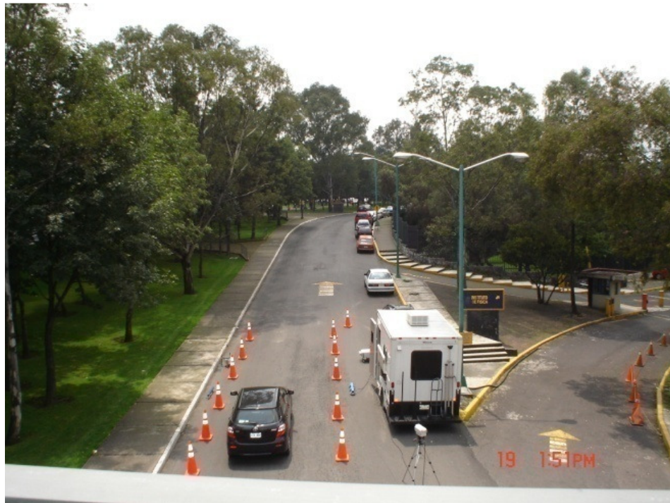
Figura 9 ARREGLO VIAL DEL SENSOR REMOTO
