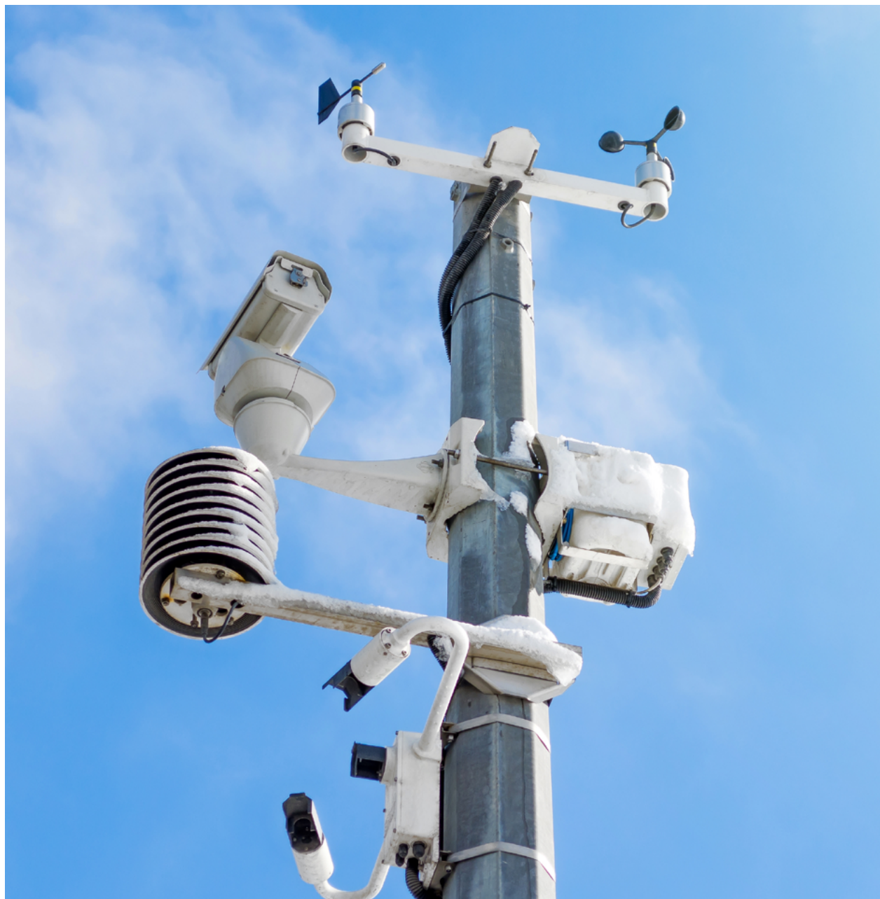
Fotografía 23. Estación meteorológica automática equipada con un sistema integrado de sensores ambientales y cámaras de video para observación en tiempo real. Dispositivo utilizado para el monitoreo climático, de condiciones atmosféricas. SEMARNAT.
