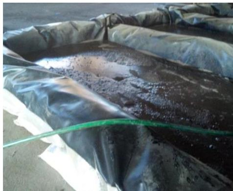
Figura 36. Adición de agua y tapado de celdas.
