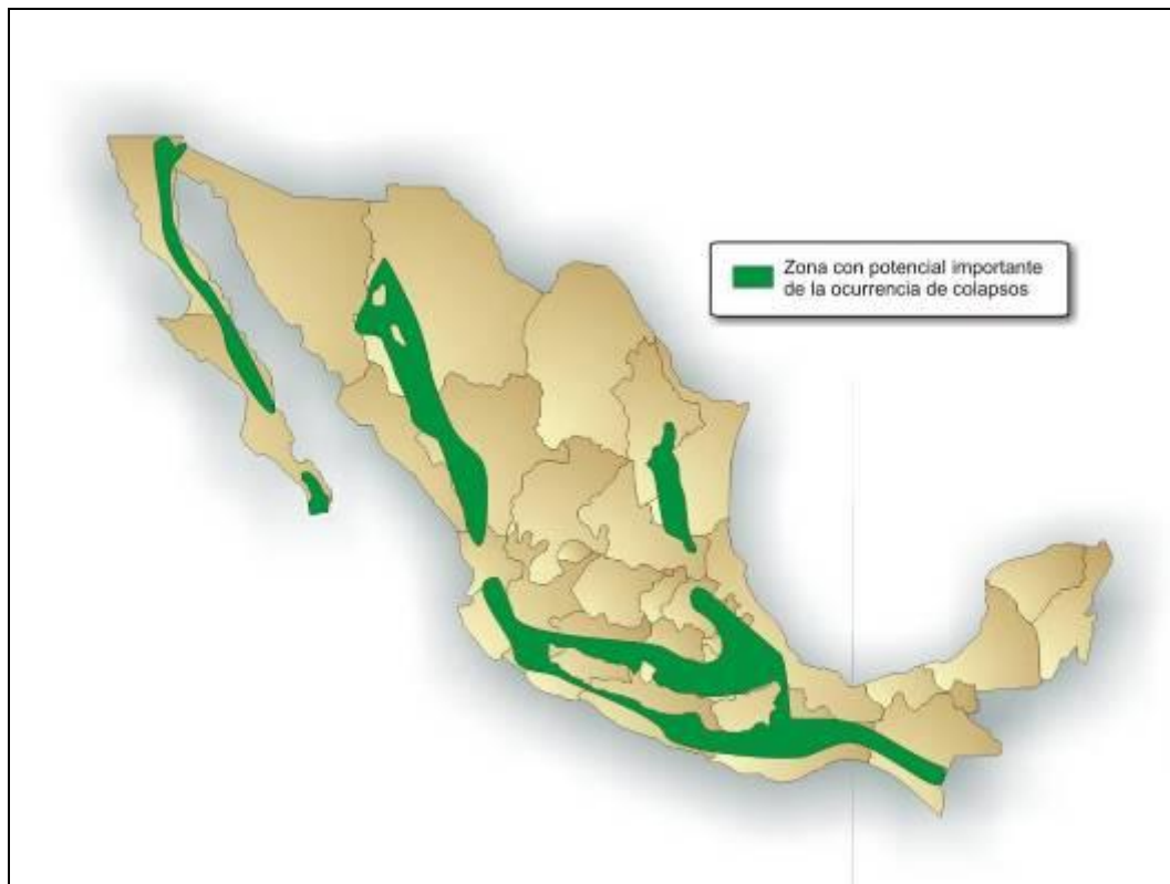
Figura I-44 Zonas con alto potencial de colapso
