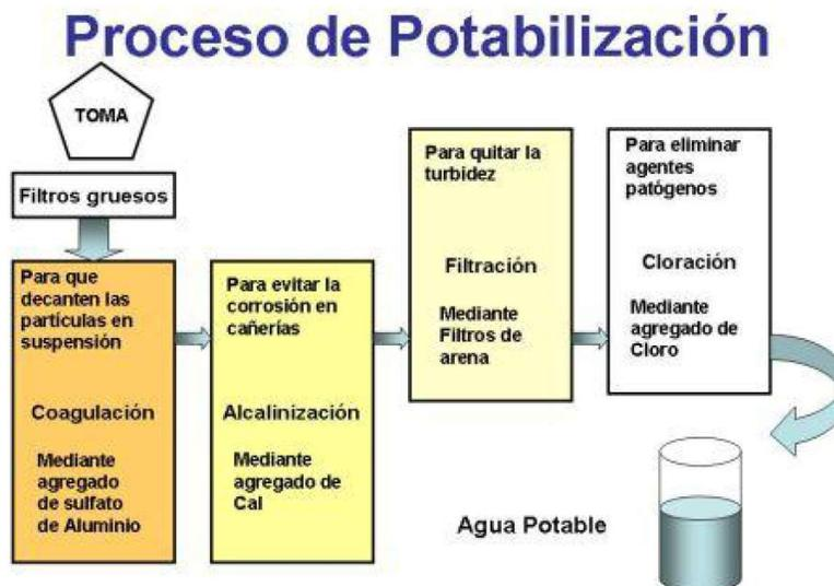
**Figura 2.2.- Proceso de potabilización del agua**
