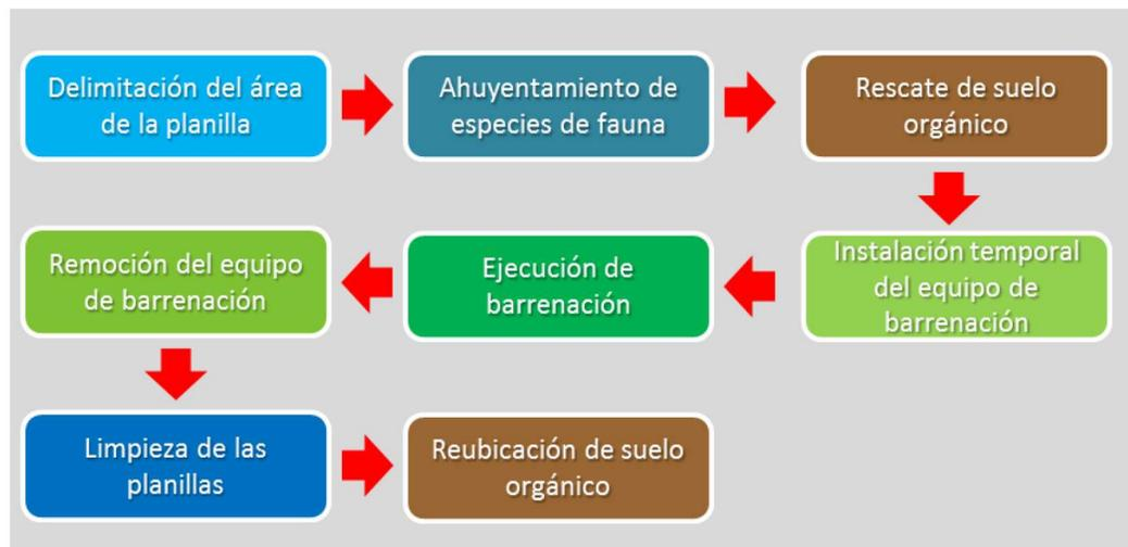
**Figura II.10. Secuencia para el acondicionamiento de las planillas de barrenación**
