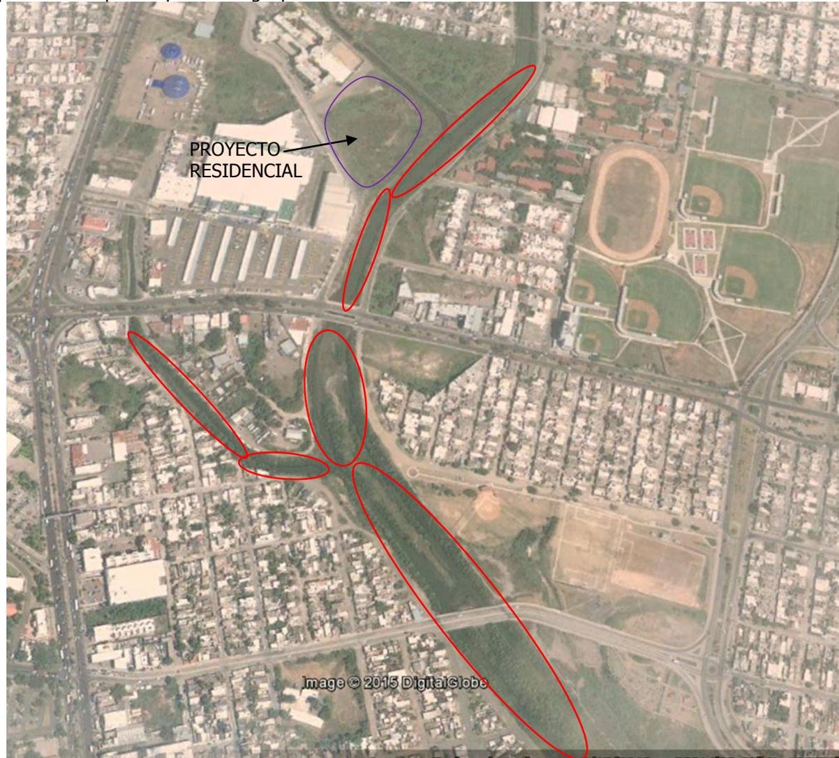
FIGURA 6. Foto actual de las áreas desasolvada y dragadas, se observa totalmente despejadas, exseptuando el canal pluvial de Av. Insurgentes al Arroyo Jabalines, el cual requiere nuevamente del retiro de vegetación en sus orillas.
