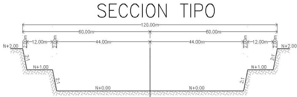
**Profundidad de la cubeta:** Toda vez que el terreno natural presenta distintas elevaciones, los trabajos de excavación para la construcción de la cubeta fluctuará entre los 2.00 metros como mínimo a 6.49 metros como máximo. La profundidad de la cubeta con base al nivel de agua en promedio a lo largo del tramo será de 4.02 metros.
