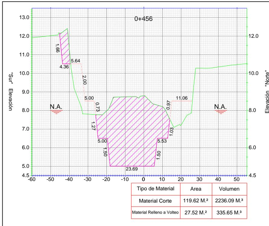
La línea verde representa el terreno natural, lo achurado en color magenta es la sección o cubeta que se formara con el corte (extracción del material, dragado), y las medidas son las indicadas en cada una de ellas, en esta sección por ejemplo en la margen derecha tendrá dos terrazas de 5.53 y 11.00 m respectivamente, en la izquierda se tendrán tres tarrazas; dos que miden 5.00 m y una que mide 10.00 m.
