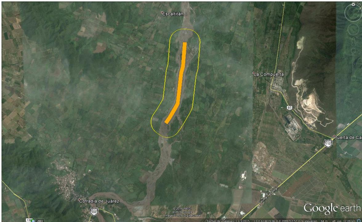
*Imagen del sistema obtenida con el programa ArcMap 10.3, con el cual se determinó un área de amortiguamiento (buffer) de 500 metros a la redonda.*
