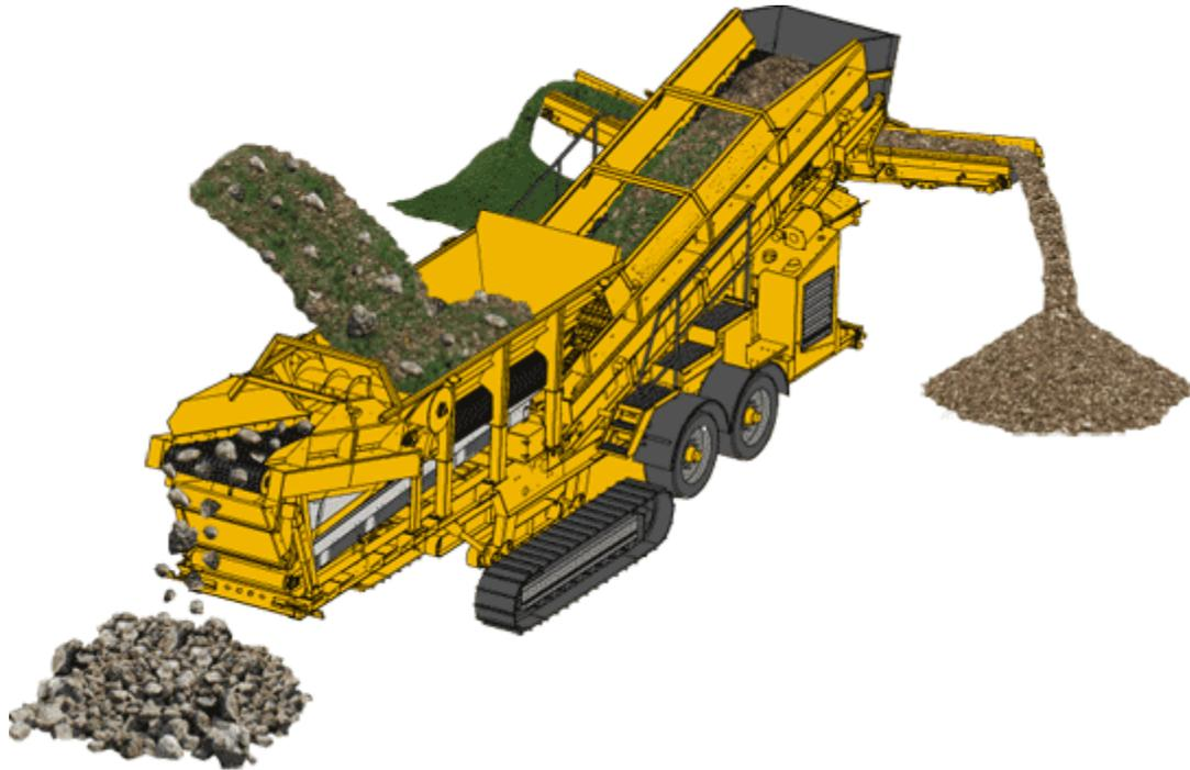
**Imagen del tipo de trituradora que se requerirá para aprovechamiento de material.**
