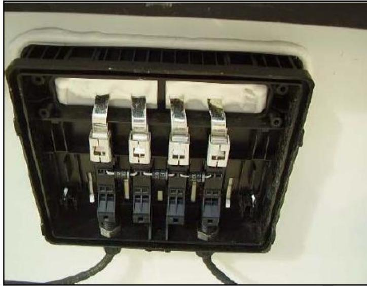
**Figura II.3.** Caja de conexiones de un módulo fotovoltaico.
