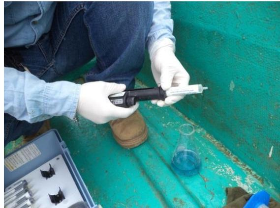
Titulación de muestra para determinar la Dureza
