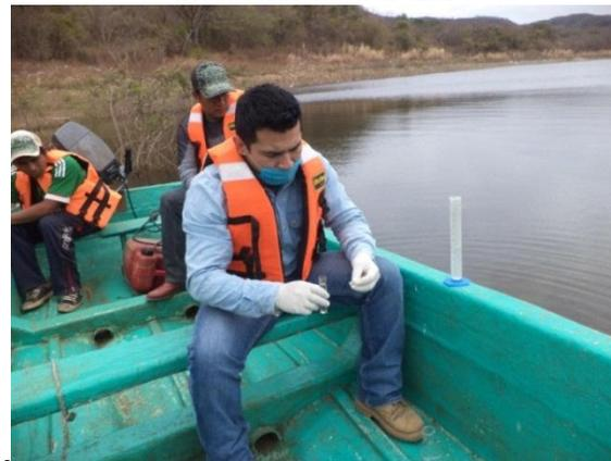
Toma de muestra de agua en tubos de ensaye para determinar pH.
