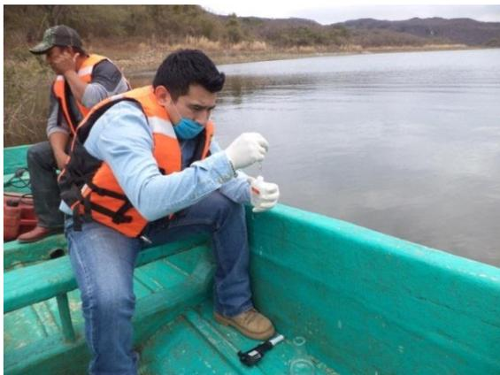
Muestra de agua para determinar dureza.
