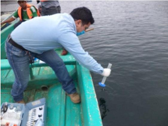
Toma de muestra de agua para determinar alcalinidad
