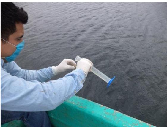
Toma de muestra de tubos de ensaye para determinar pH
