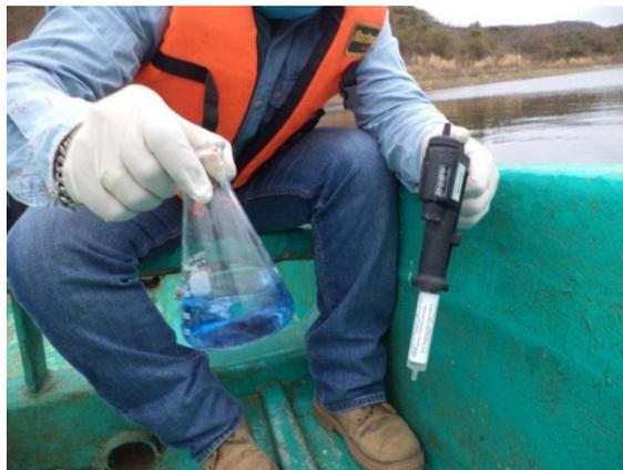
Titulación de la muestra con reactivo indicador de dureza.
