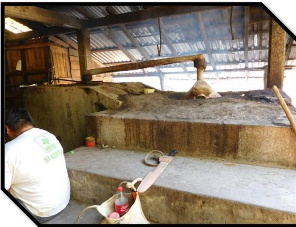
Figura 29. En primer plano se observa la olla donde el producto fermentado es destilado, y al fondo el tanque de condensación del producto.
