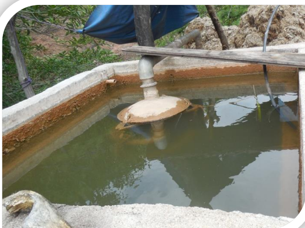
Figura 29. Tanque donde se lleva a cabo la condensación del mezcal.
