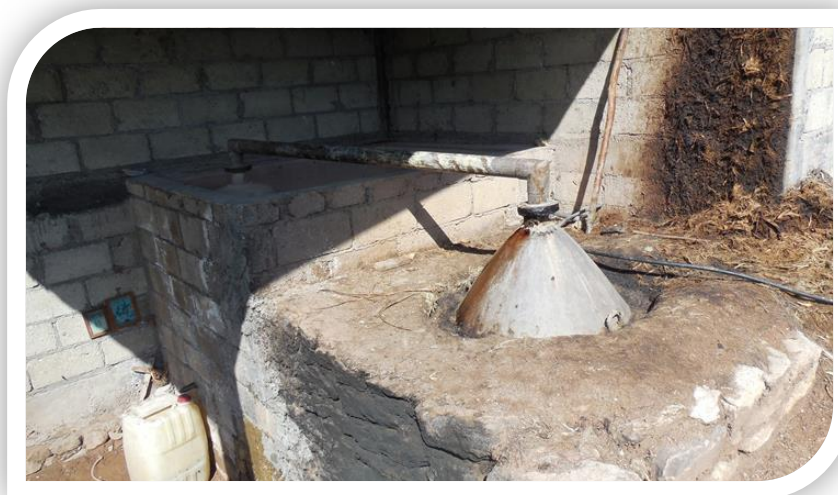
Figura 27. Horno donde se lleva a cabo la destilación, y tanque para la condensación del producto, en la parte inferior izquierda se muestra una garrafa donde se acopia el mezcal procesado.
