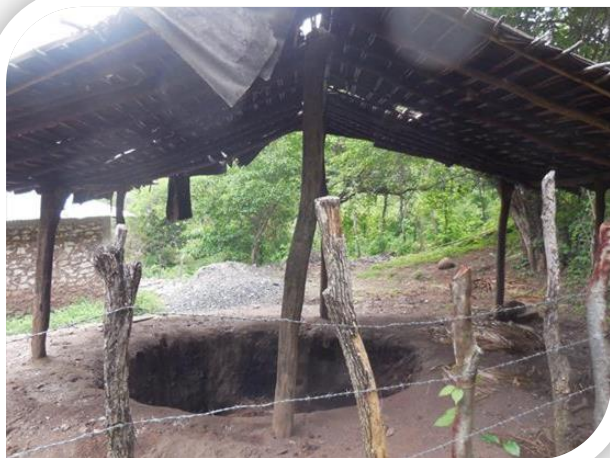
Figura 25. Horno para la cocción de las piñas de maguey.
