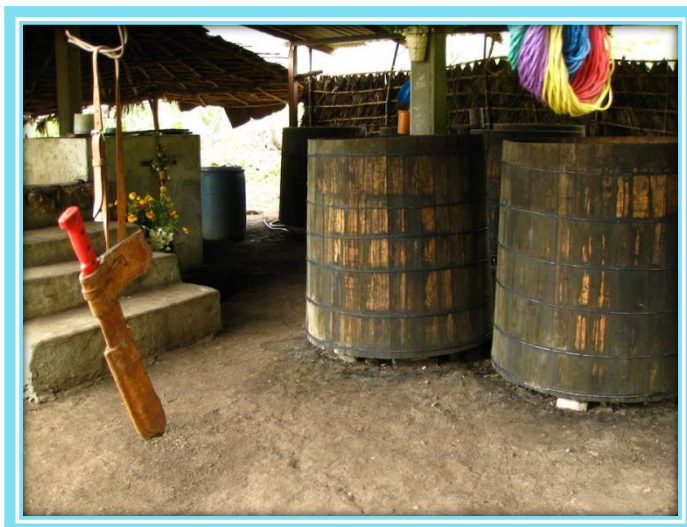
Figura 25. Las piñas posteriores a ser picadas son colocadas en los tanques para su fermentación.
