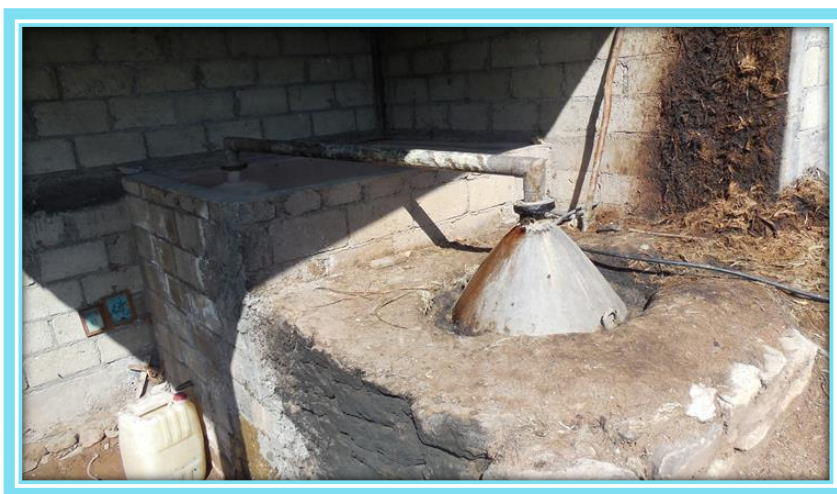
Figura 26. Horno donde se lleva a cabo la destilación, y tanque para la condensación del producto, en la parte inferior izquierda se muestra una garrafa donde se acopia el mezcal procesado.
