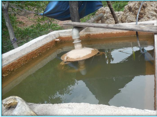
Figura 27. Tanque donde se lleva a cabo la condensación del mezcal.
