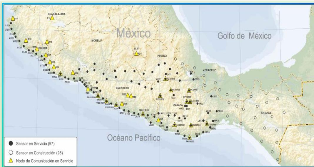
Figura 37. Sistema de Alerta Sísmica Mexicano (SASMEX®)
