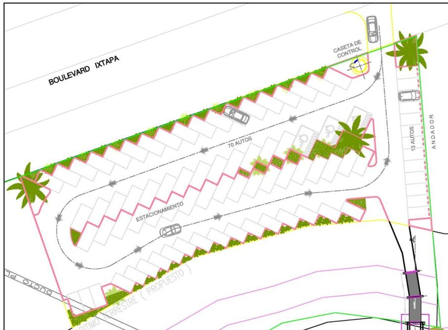
**Figura II.3. Planta general del estacionamiento, junto al Bulevar Ixtapa.**
