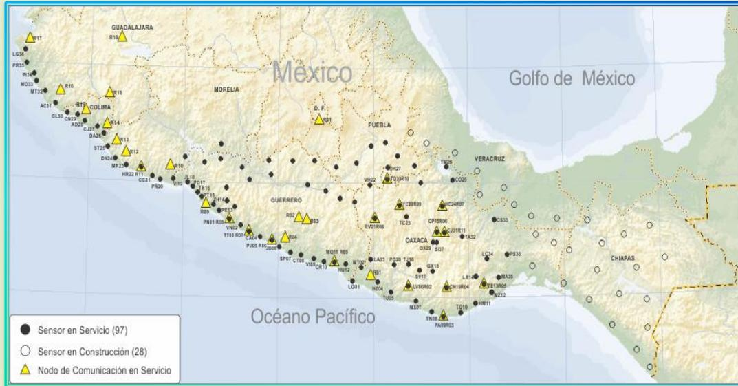
Figura 13. Sistema de Alerta Sísmica Mexicano (SASMEX®)
