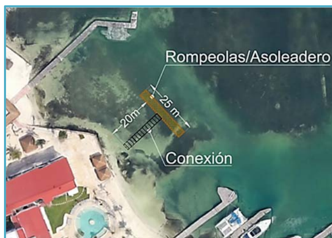
Figura II_ 7. Habilitación de rompeolas paralelo a la línea de costa con conexión.
