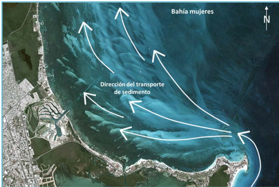
Figura IV_ 14. Transporte de sedimento en Bahía Mujeres (dunas submarinas).
