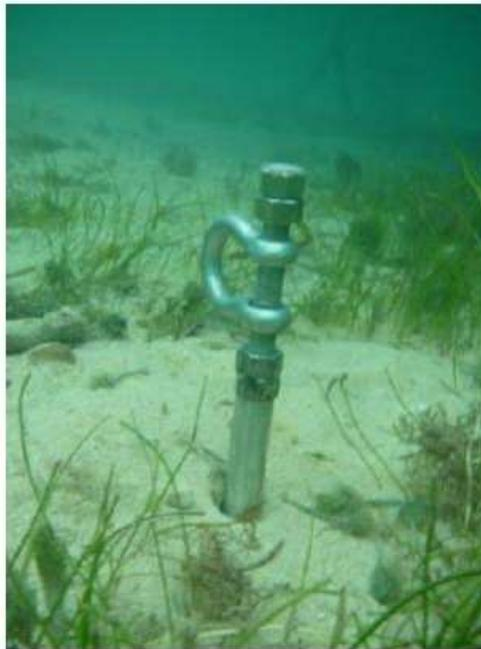
Sistema de fijación (Tipo alcayata) con capacidad de 1.5 toneladas.
