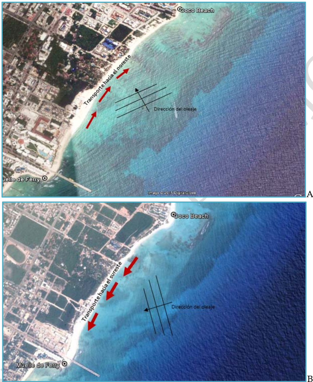
Figura IV_ 10. Basculación del sedimento según la dirección del oleaje entre el Hotel The Reef Coco Beach y el muelle de Ultramar. Fuente: Análisis de erosión en playas adyacentes al Hotel The Reef Coco Beach, PROCOMAR 2015.
