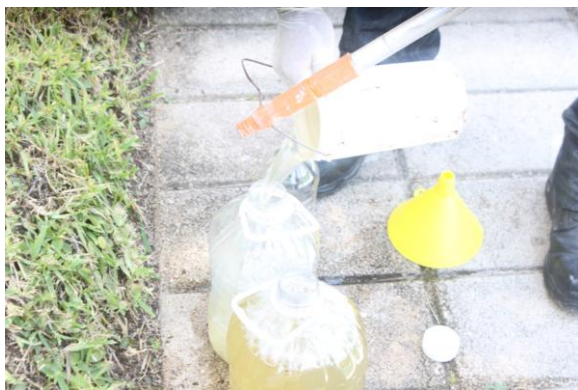
Figura II.4. Muestreo compuesto de los efluentes de Las Villas.
