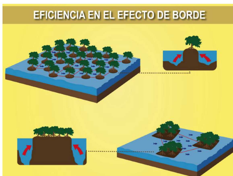
Figura 21. Comparación entre chinampas y tarquinas. Arriba: chinampas de 1 m 2 con un mayor espejo de agua disponible para la fauna acuática y mayor superficie de contacto en las paredes de cada isla. Abajo: Mayor cantidad de sedimento requerido para construir una tarquina de 10m 2 , menos espejo de agua disponible para la fauna y menor superficie de contacto en las paredes de la isla.
