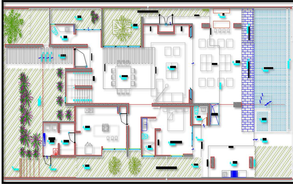
**Figura II.1.** Plano arquitectónico del desplante de la Planta Baja con una superficie de 365.54 m<sup>2</sup>
