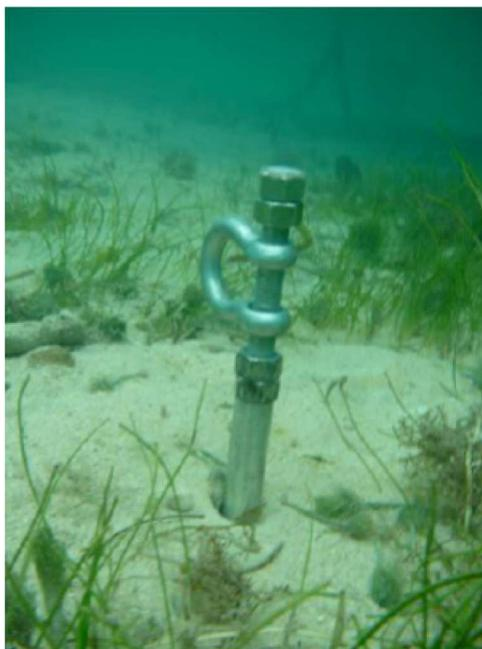
Sistema de fijación (Tipo alcañata) con capacidad de 1.5 toneladas.
