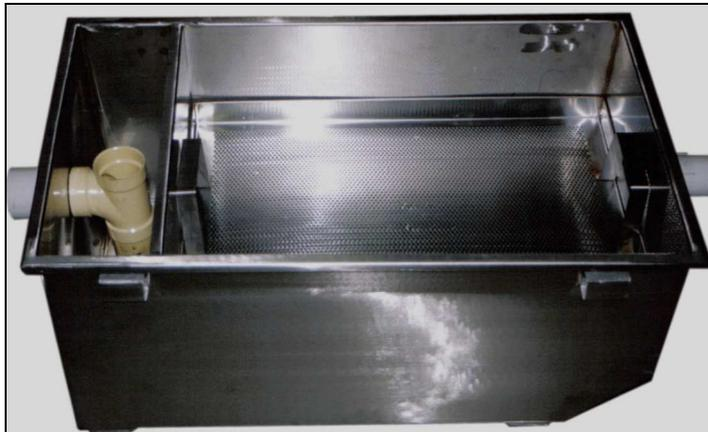
Fabricada totalmente en lámina de acero inoxidable calibre 18. Patas en el mismo material con tornillos de nivelación; tapa asegurada al cuerpo de la trampa por medio de broches de presión. Incluye una pieza de acero inoxidable, removible, para retener los sólidos y permitir el retiro de las grasas retenidas. Para una correcta instalación es necesario bajar el desagüe a nivel de piso, para facilitar la limpieza periódica de la trampa.
