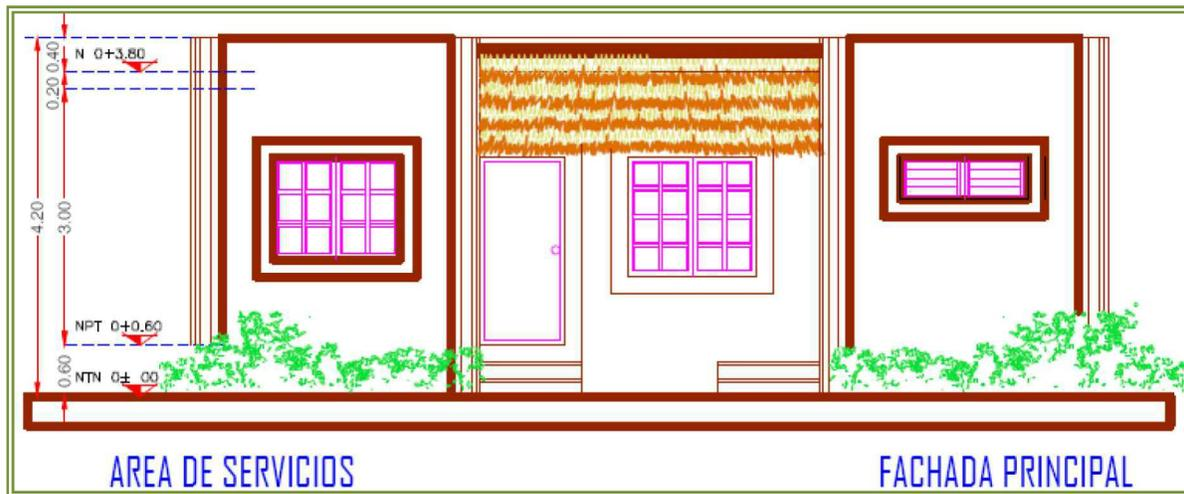
El módulo 2 es una estructura destinada a albergar dos bodegas, el cuarto del velador, medio baño y un cuarto de herramientas. Tendrá una superficie de 48.80 m<sup>2</sup> y una altura de 4.20 ml, desplantada sobre una losa de cimentación de 0.35 ml, para un total de 4.55 ml. En azotea se contará con 1 tinaco de 750 lts (\*Para detalles favor de consultar planos adjuntos).
