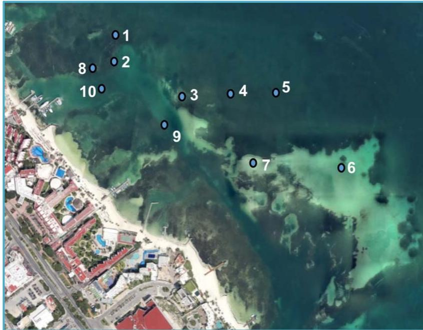
Figura IV\_ 21. Sitios donde se llevaron a cabo los sondeos de espesor de arena y profundidad.
