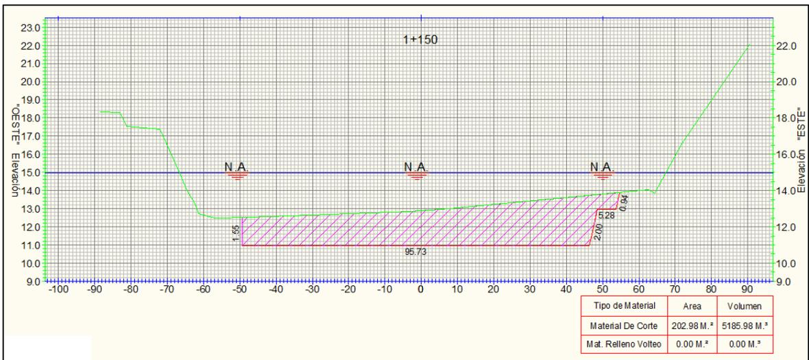
La línea verde representa el terreno natural, lo achurado en color magenta es la sección o cubeta que se formara con el corte (extracción del material, dragado), y las medidas son las indicadas en cada una de ellas, en esta sección por ejemplo no se tendrán terrazas fuera del nivel del agua en época de estiaje.
