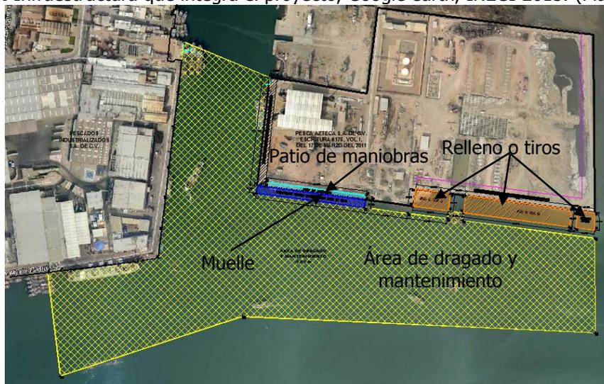
Para realizar un proceso de dragado es necesario considerar las características Físicas del lugar de dragado, el sitio de depósito, las propiedades físicas y químicas del material que se quiere extraer, la proporción del material, las particularidades del entorno, entre otras características. Con el fin de tener una mejor idea del proyecto de dragado, es necesario revisar el tipo de sedimentación del área a dragar y el material extraído en dragados realizados con anterioridad en el área.
