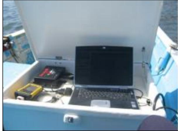
El equipo se montó en una embarcación y se operó en conjunción con un sistema GPS de doble frecuencia marca Spectra Precision modelo EPOCH 25 RTK (Fig. 14), con la capacidad de resolver la posición y la altura de un punto en tiempo real con precisión subcentimétrica.
