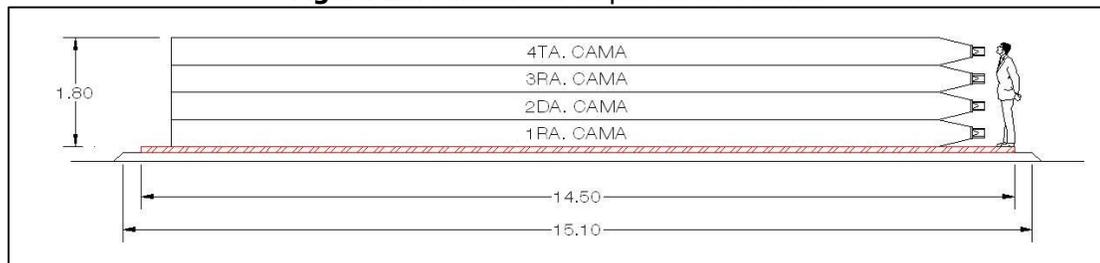
Una vez que se haya realizado la fabricación de la plataforma, sobre ésta se realizarán las actividades de habilitado, armado, y colocación del acero de refuerzo de los pilotes, así como la fabricación y colocación del regatón y del chiflón.
