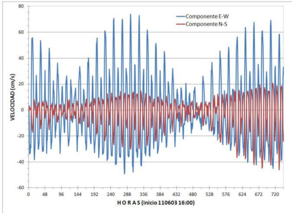
**Figura 40.** Velocidades registradas en la superficie y en el fondo estero de Uriás.
