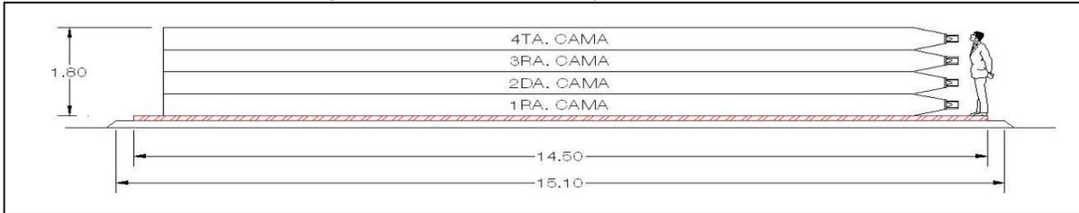
Una vez que se haya realizado la fabricación de la plataforma, sobre ésta se realizarán las actividades de habilitado, armado, y colocación del acero de refuerzo de los pilotes, así como la fabricación y colocación del regatón y del chiflón.
