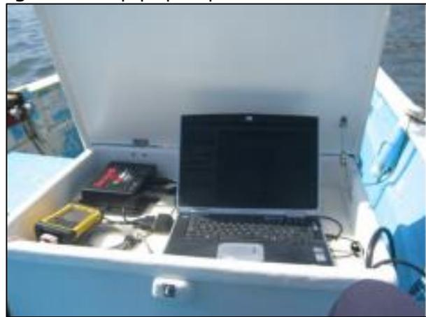
El equipo se montó en una embarcación y se operó en conjunción con un sistema GPS de doble frecuencia marca Spectra Precisión modelo EPOCH 25 RTK (Fig. 14), con la capacidad de resolver la posición y la altura de un punto en tiempo real con precisión subcentimétrica.
