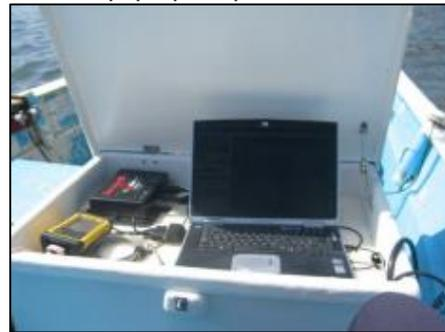
El equipo se montó en una embarcación y se operó en conjunción con un sistema GPS de doble frecuencia marca Spectra Precision modelo EPOCH 25 RTK (Fig. 15), con la capacidad de resolver la posición y la altura de un punto en tiempo real con precisión subcentimétrica.
