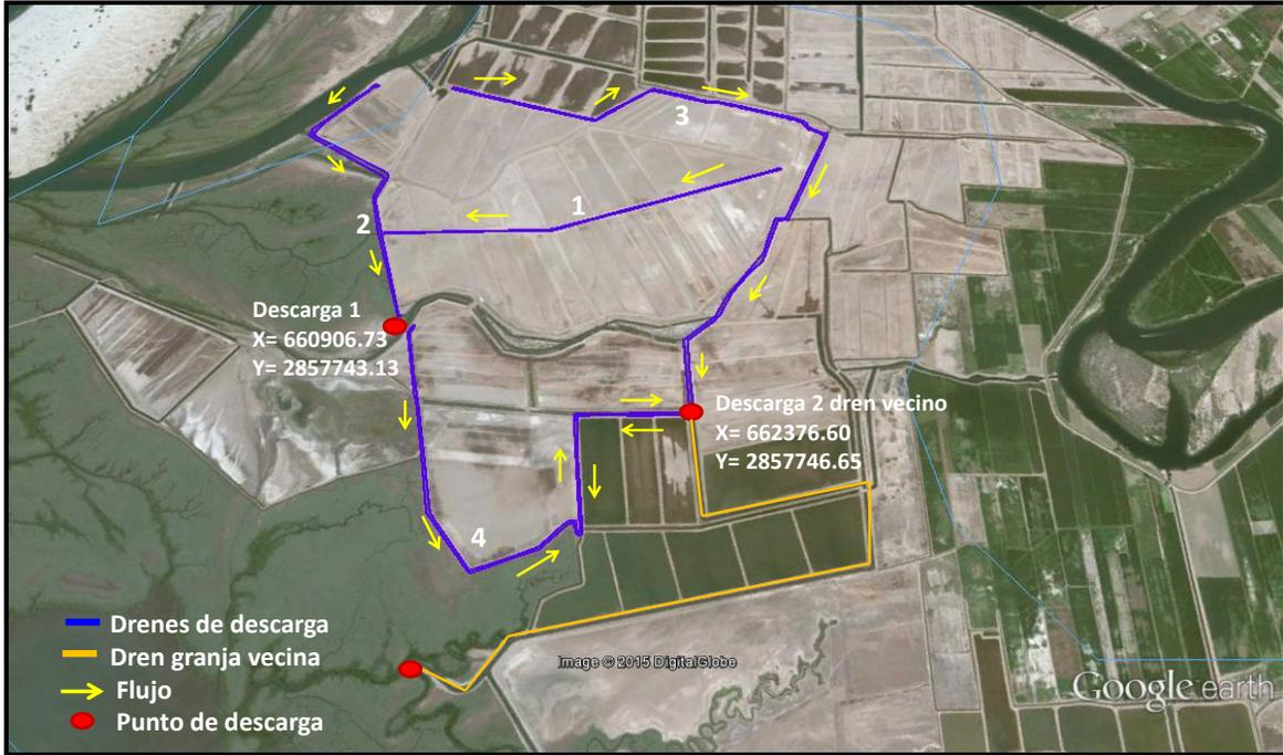
**Figura II.4** Drenes con sus flujos y puntos de descarga
