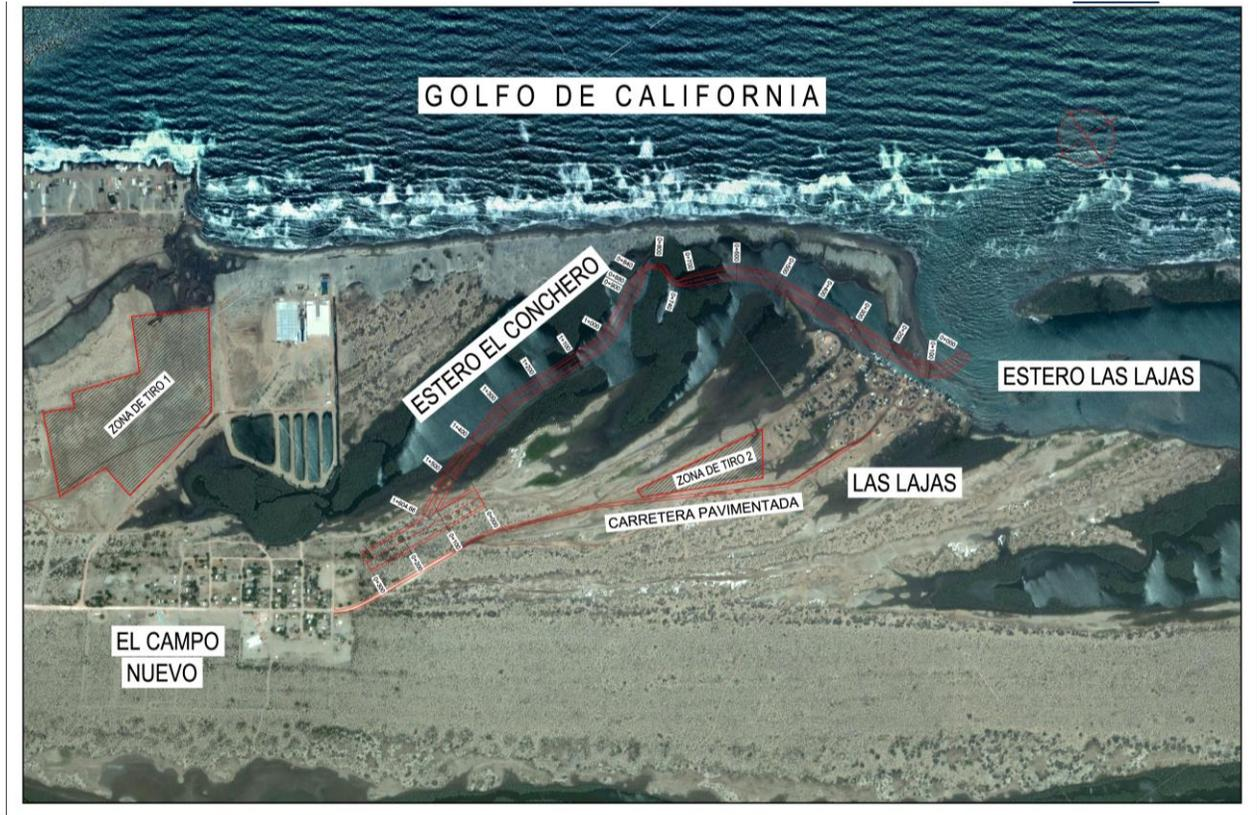
Figura II.4. Arreglo general del Canal a desazolver, las dos zonas de tiro y la dársena pesquera.
