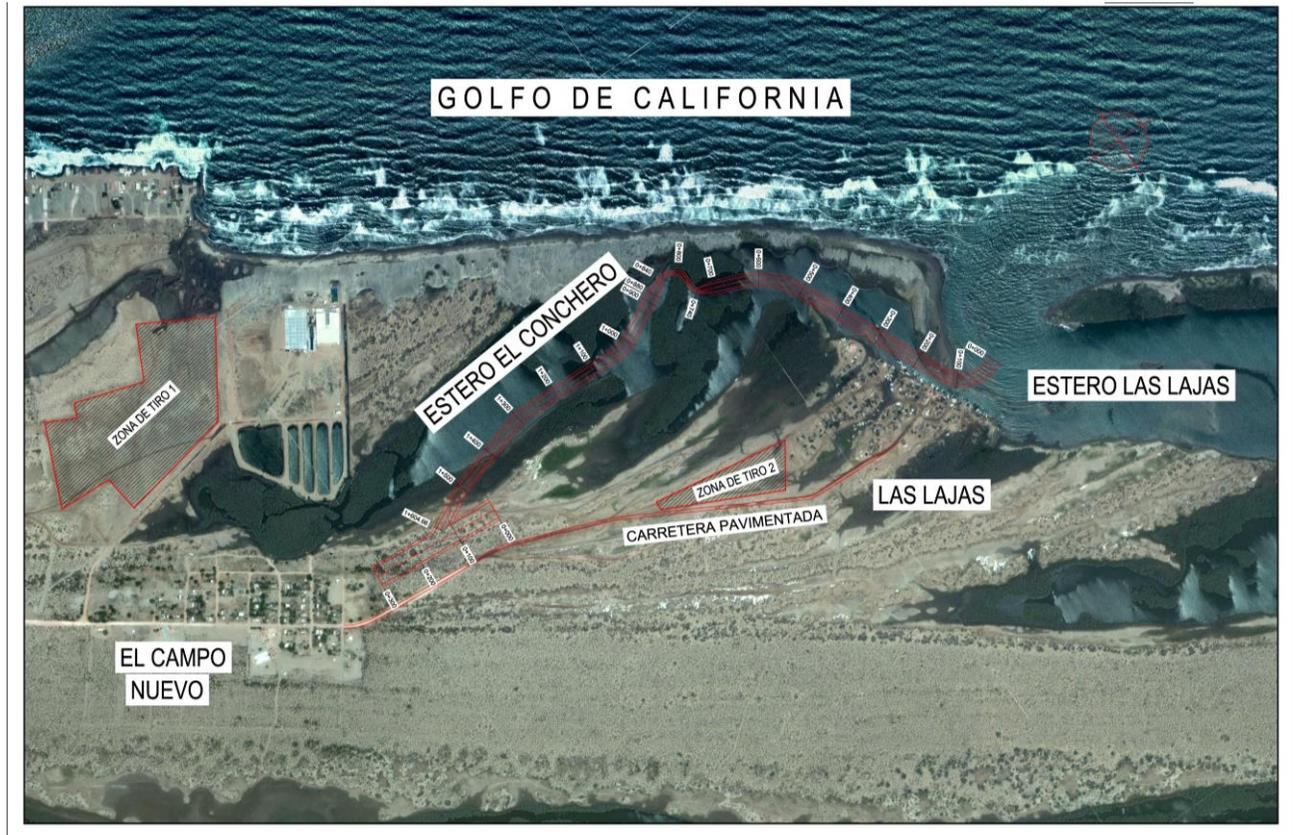
Figura II.1. Planta General del Proyecto donde se muestran el Canal Concheros, las Zonas de Tiro propuestas y la Dársena Pesquera.
