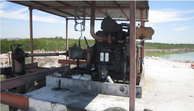
Motor de combustión interna diésel que se programa sustituir por eléctrico
