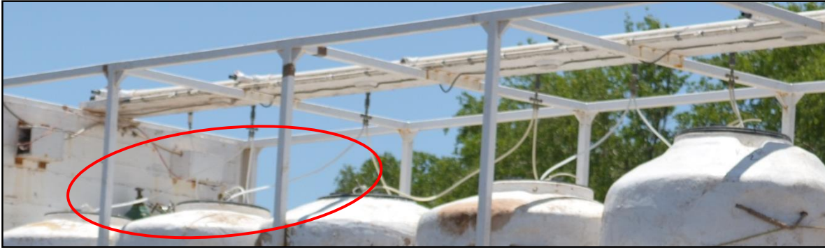
Sistema de oxigenación a los contenedores durante el transporte.
