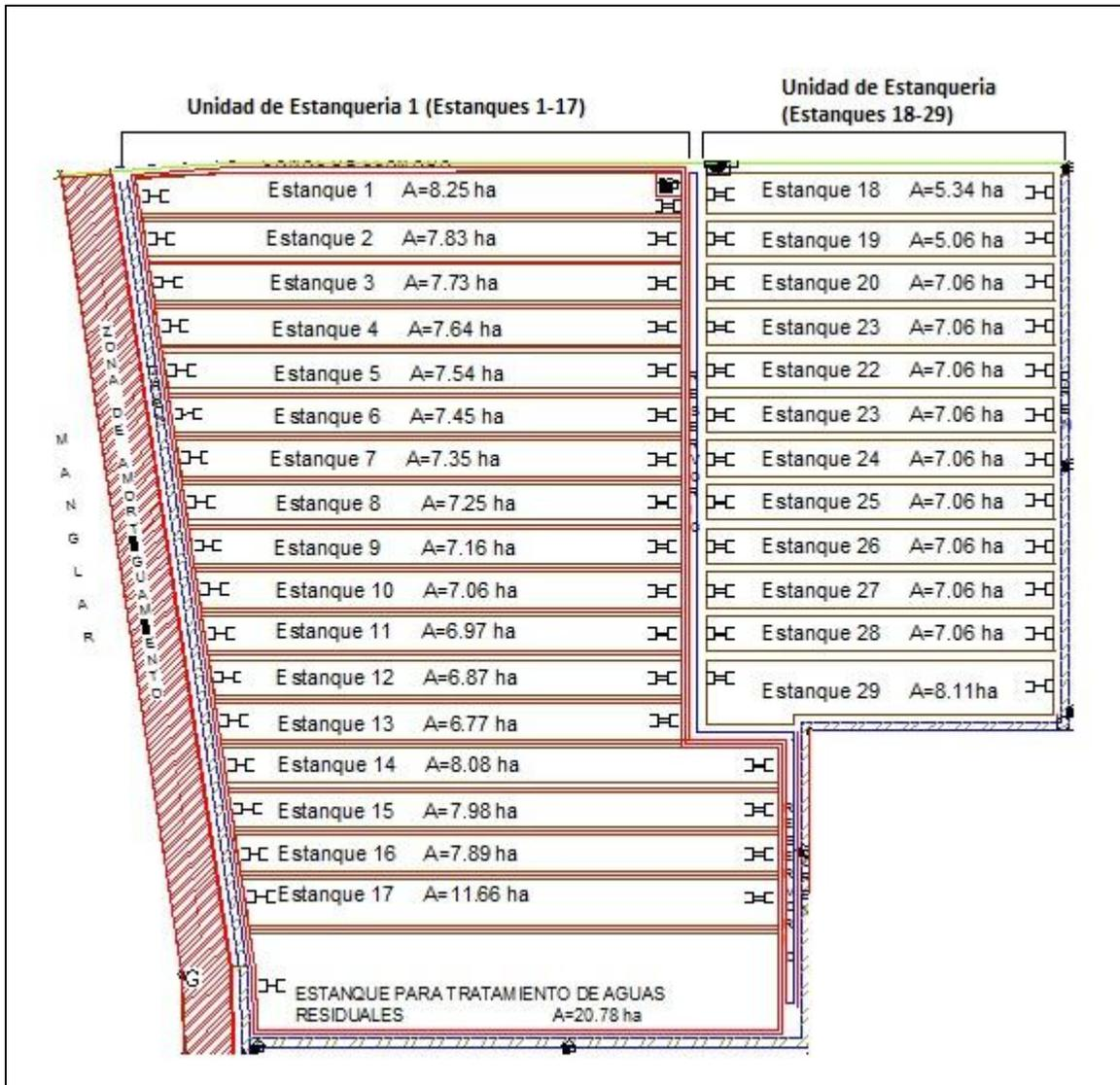
Los estanques estarán conformados por el bordo perimetral y bordo interior, ambos tipos son de forma trapezoidal con una altura promedio de 2 m, corona de 4.0 m y los taludes de 3:2 en el lado interno y en la parte exterior.
