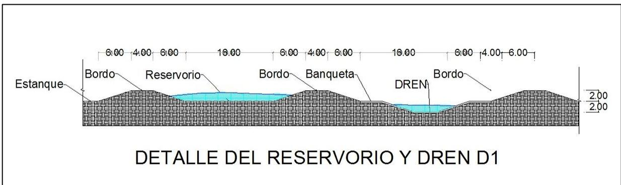
El producto de la excavación será utilizado en la construcción de la bordería, será un volumen total de tierra en bordos de 784,953.6 m<sup>3</sup>.
