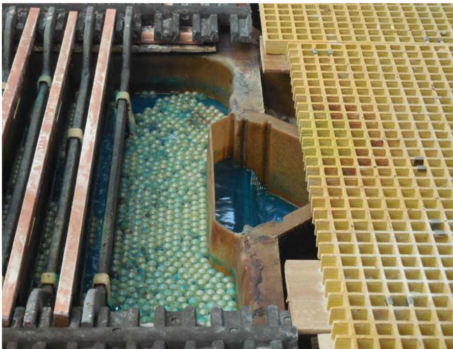
**Figura 2.6** Control de los vapores ácidos a través de cama de polietileno flotante en forma de grageas
