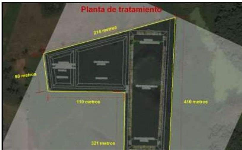
Fig.4.Dimensiones de la Planta de tratamiento de aguas residuales.
