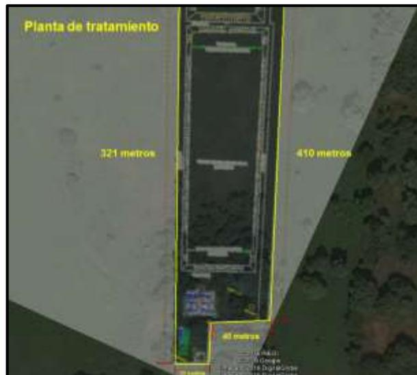
Fig.5.Dimensiones de la Planta de tratamiento.
