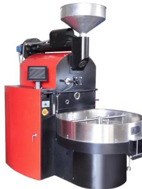
de café. Tostador por convección con agitador de paletas, incluye compuertas de auto descarga, elevador por vacío de granos verdes y carrito para granos verdes con báscula. Con capacidad de 70kg por ciclo contando con las siguientes ventajas:
