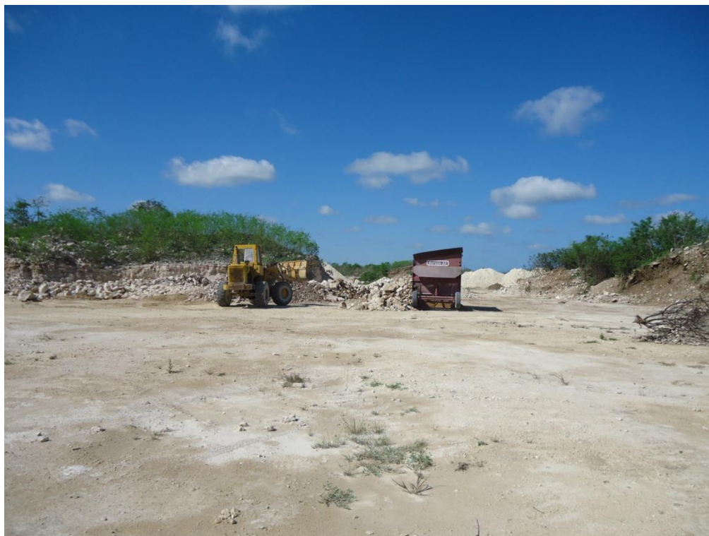
Fotografía 2. 2 Ejemplificación del retiro de montículos de despálme y cribado para la obtención de rocas para triturar.
