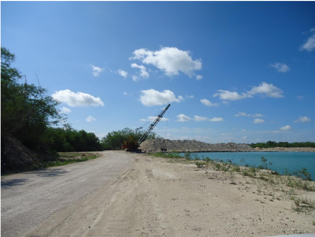
Fotografía 2. 4 Ejemplificación de una draga línea extrayendo material en estrato húmedo.
