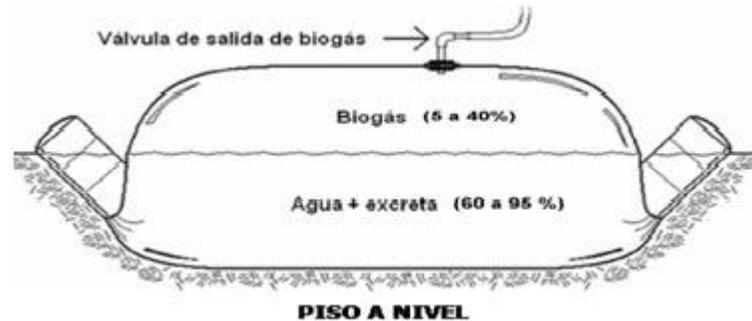
Figura 2. 25. Funcionamiento del biodigestor de Geomembrana
