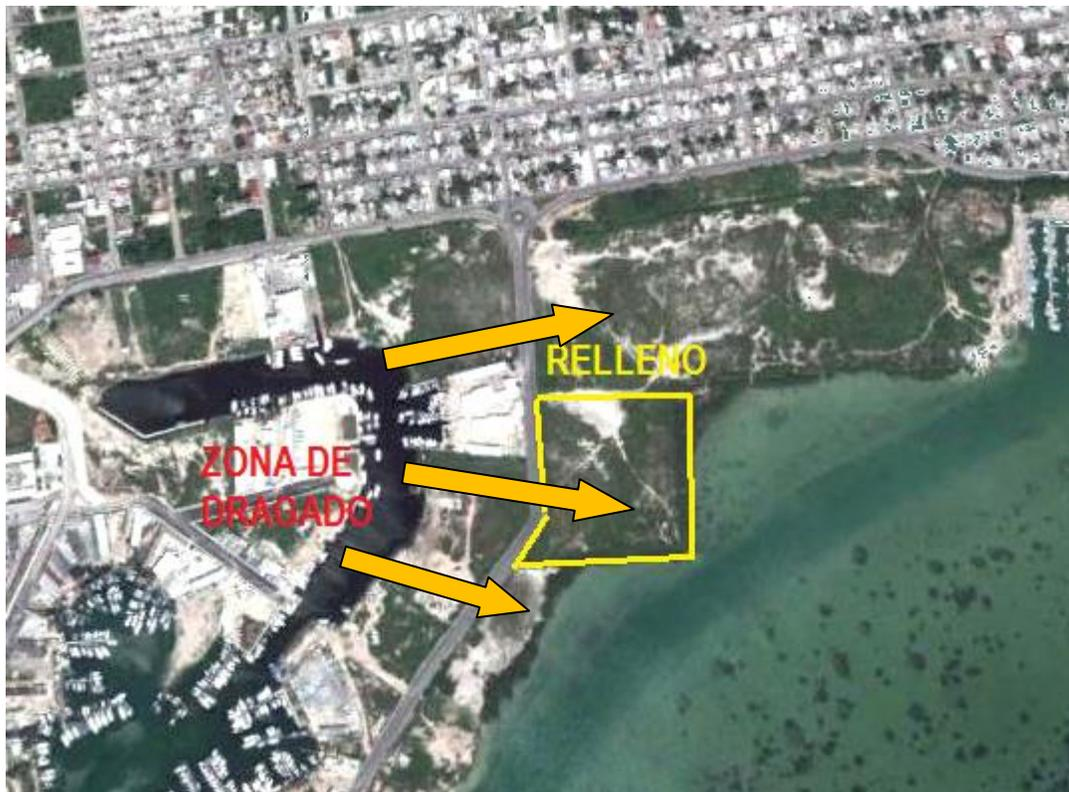
Fotografía en la que se muestra el dragado del canas adyacente.
