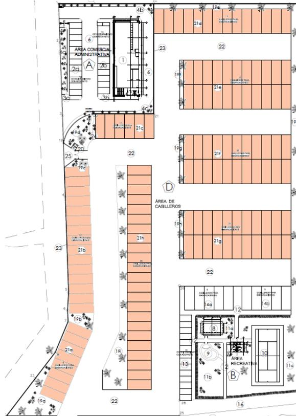
**21. Vialidad sascab.** Tiene una superficie de 5,519.01 m<sup>2</sup>. Esta área será para facilitar el manejo y maniobras de las embarcaciones con sus remolques alrededor de los casilleros.
