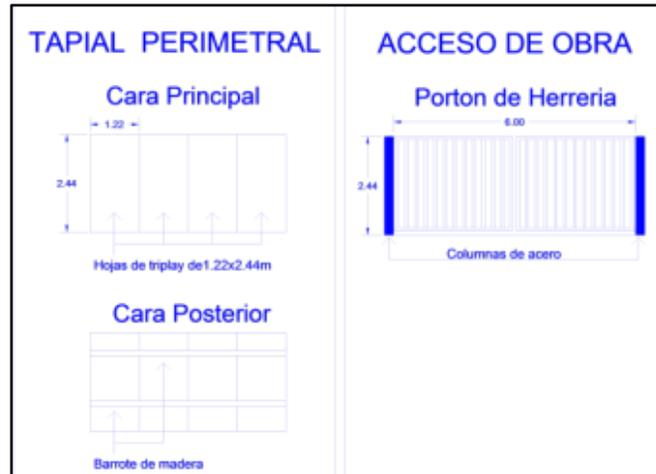
Figura 5. Dimensiones de los elementos temporales para la construcción del proyecto.
