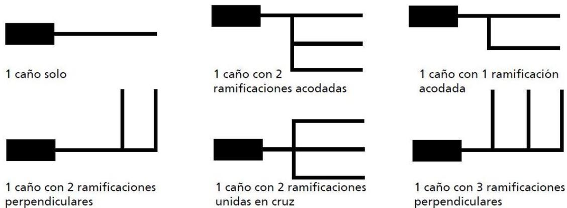
**Figura II.4.** Esquema de las diferentes disposiciones de las tuberías.
