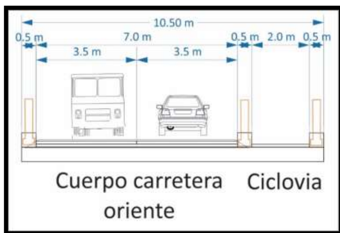
Figura II.25 Sección tipo del cuerpo oriente del proyecto eje vial “Línea Verde”
