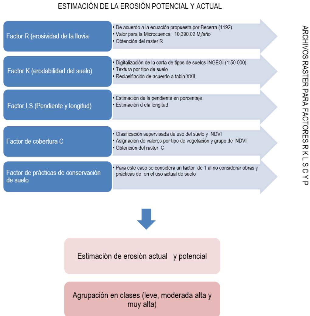
Figura 39. Proceso de generación de imágenes raster utilizadas para estimar la erosión el SA.
