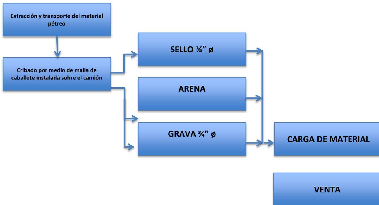
El proceso de extracción del material pétreo, es de maniobras simples, en los planos se indica la superficie a explotar, de manera directa mediante una retroexcavadora. De igual manera la retroexcavadora carga de manera inmediata a los camiones de volteo.
