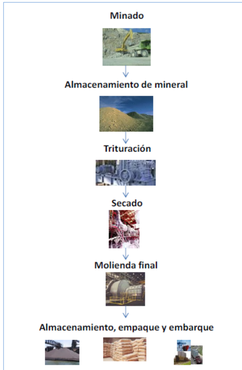
Figura 6. Proceso de aprovechamiento de Bentonita del proyecto
