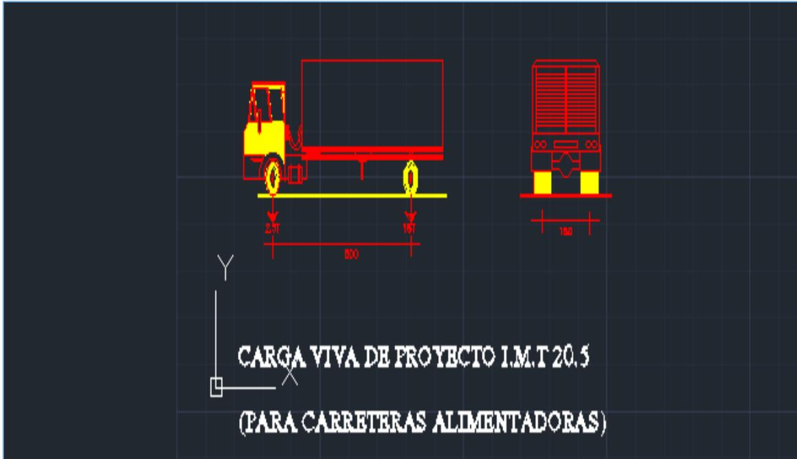
Ilustración 3. Carga vivas del puente
